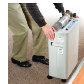
Méthode de transport incorrecte
